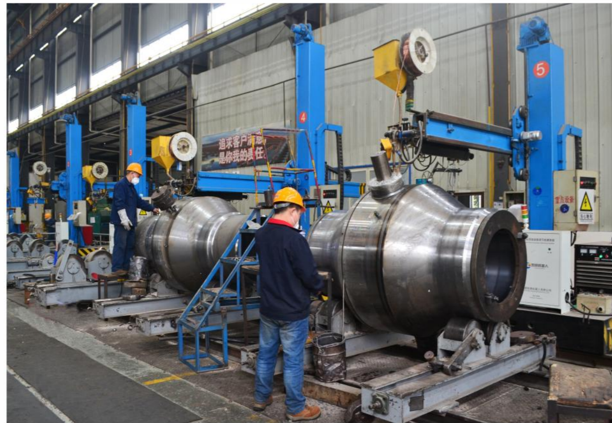
CZ02-2X2环缝焊机 [横梁伸缩有效行程：2000mm] [横梁升降有效行程：2000mm] [小臂伸缩有效行程：300mm]
