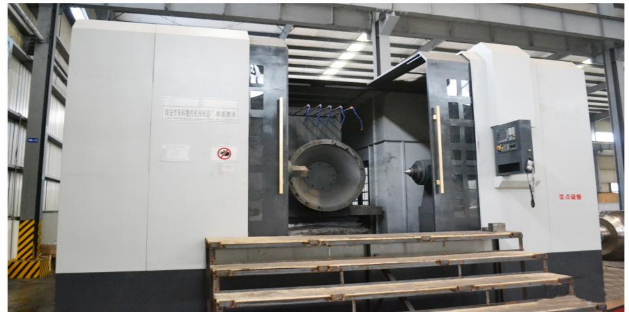
精密数控球体球面磨床 [有效加工尺寸：36寸-56寸]
