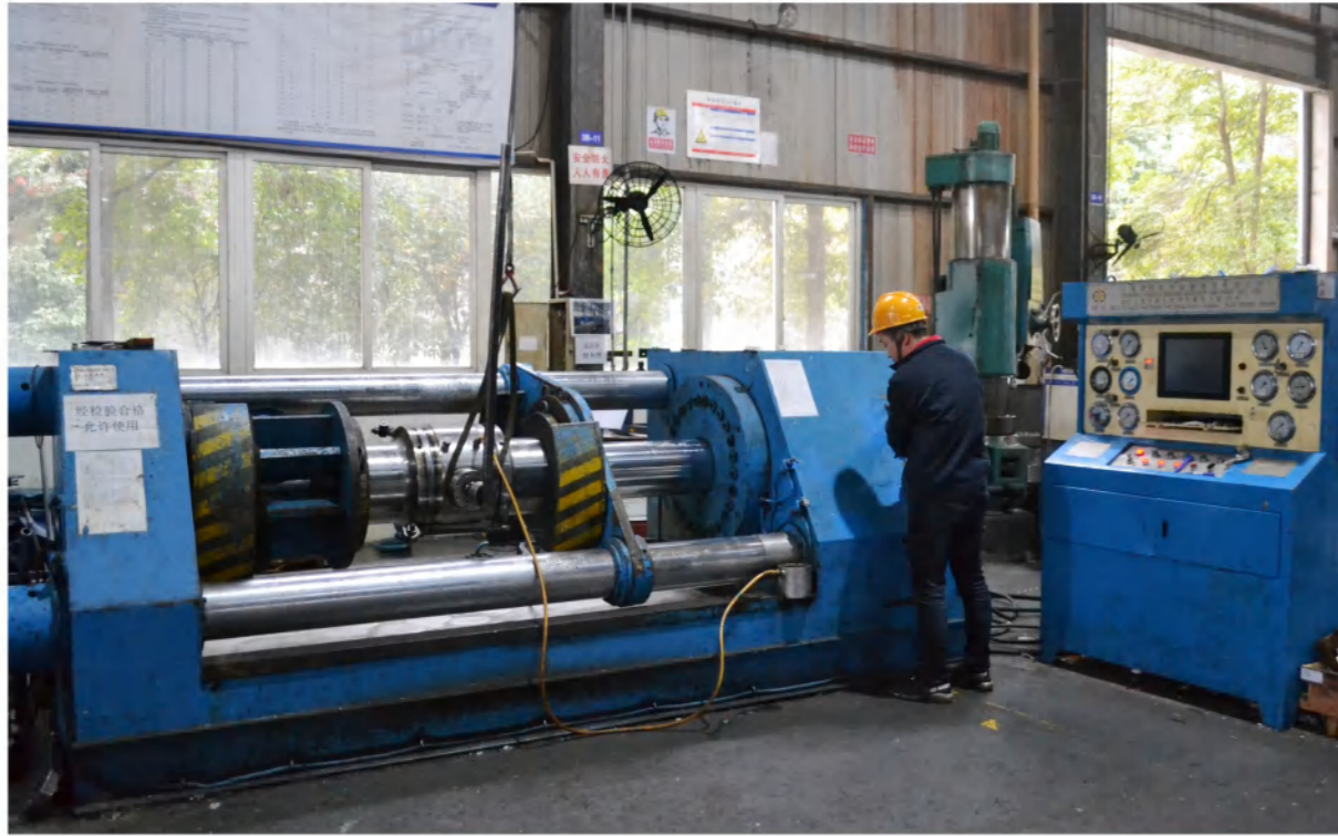
液压阀门试验台 [试验口径:NPS6~24,试验压力150Lb~2500Lb]
