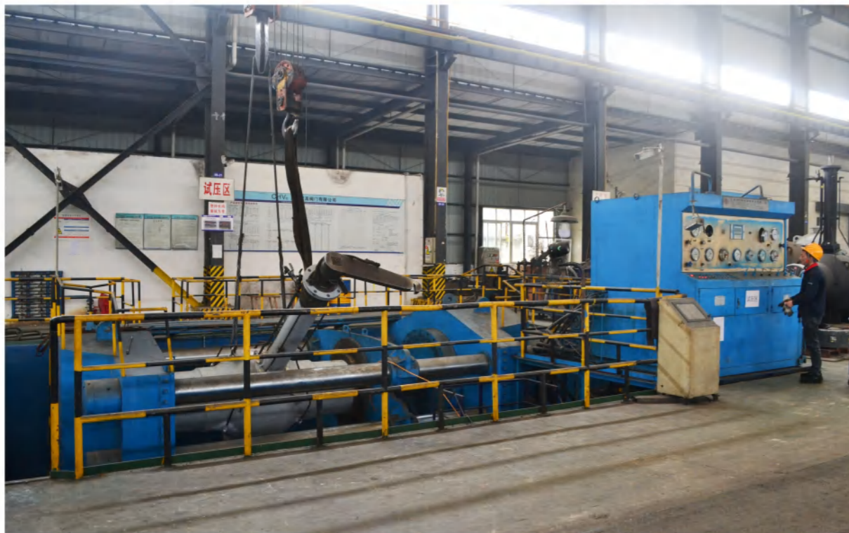
液压阀门试验台[试验口径:NPS24~56,试验压力150Lb~1500Lb]
