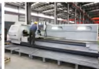
CKA 6163/4000 数控卧式车床 [有效工作尺寸：630x4000]
