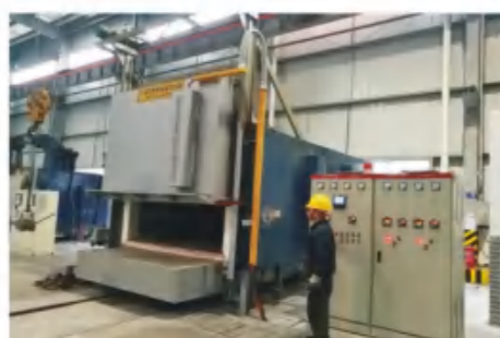
RT2-420-9台车式电阻炉 [有效工作尺寸：2000x4000x1500]
