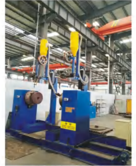
GXB-TMII 阀体环缝自动焊机 [有效工作尺寸：2000]
