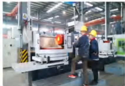
四转磨床 [有效工作尺寸：900x900]
