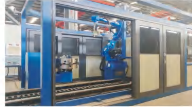
PTA-ROBOT-AC1800型机器人操作系统 大型阀门密封面数字化等离子自动堆焊机
